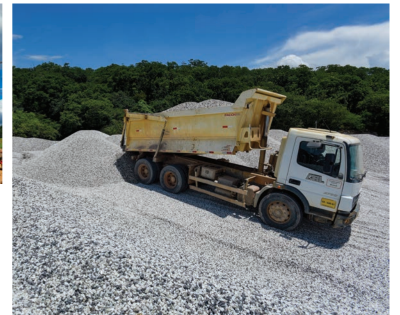
Conformação das pilhas de estéril e rejeitos na Unidade de Mineração (Araçuaí)
